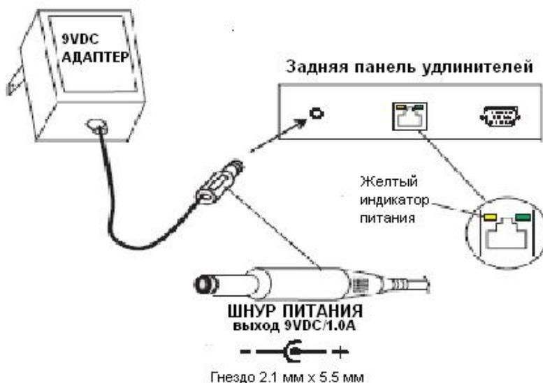
Рис.4 – Подсоединение адаптеров переменного тока к удлинителям
